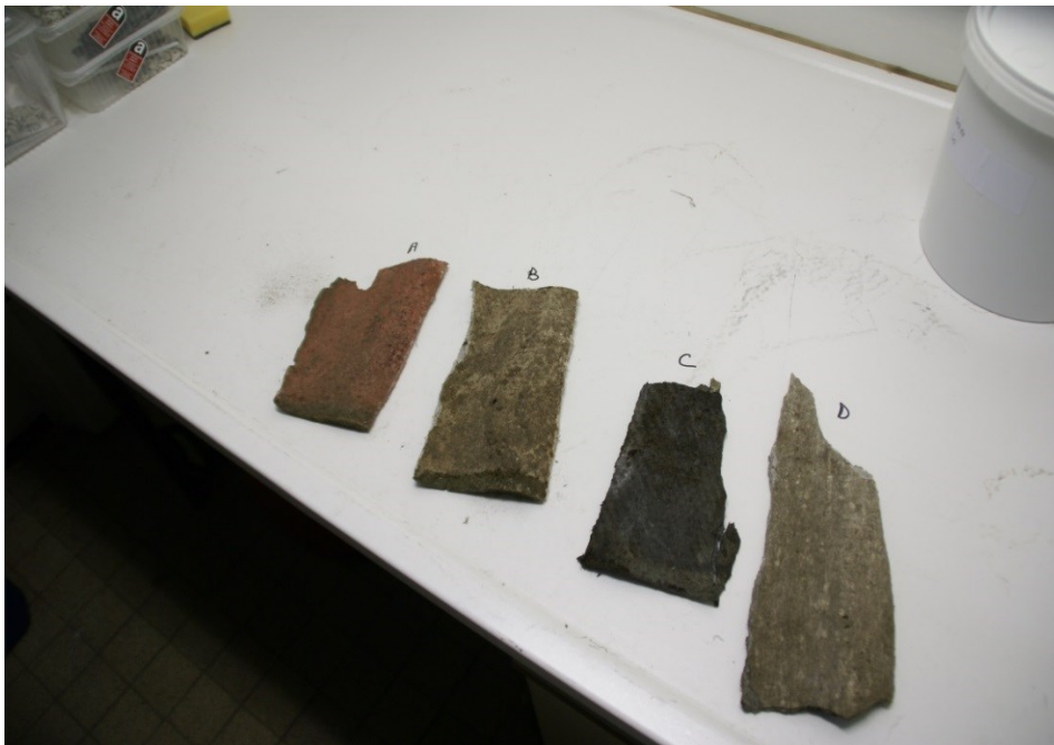
Figuur 1: Overzicht vier materialen (verweerde golfplaat) voor vochtigheidstest.
