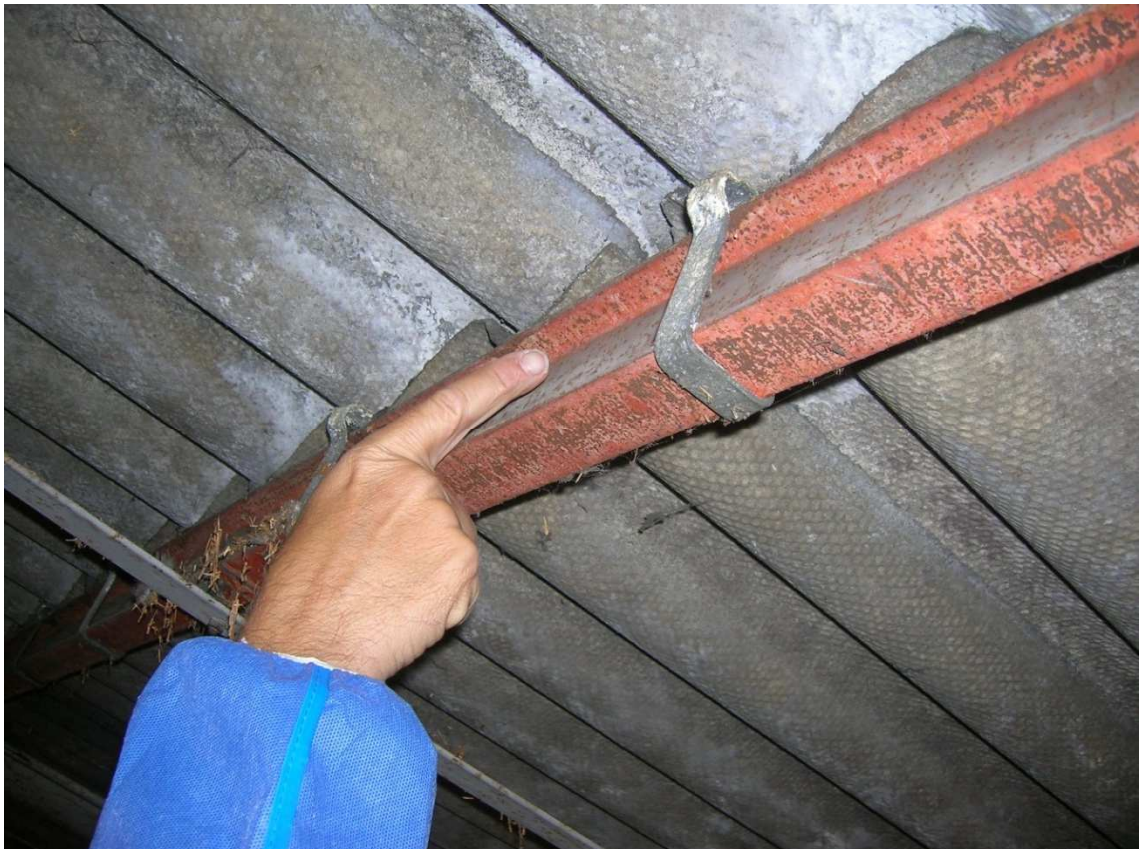
Figuur 2: De bemonstering met kleefmonsters vanop de dakdraagstructuur
