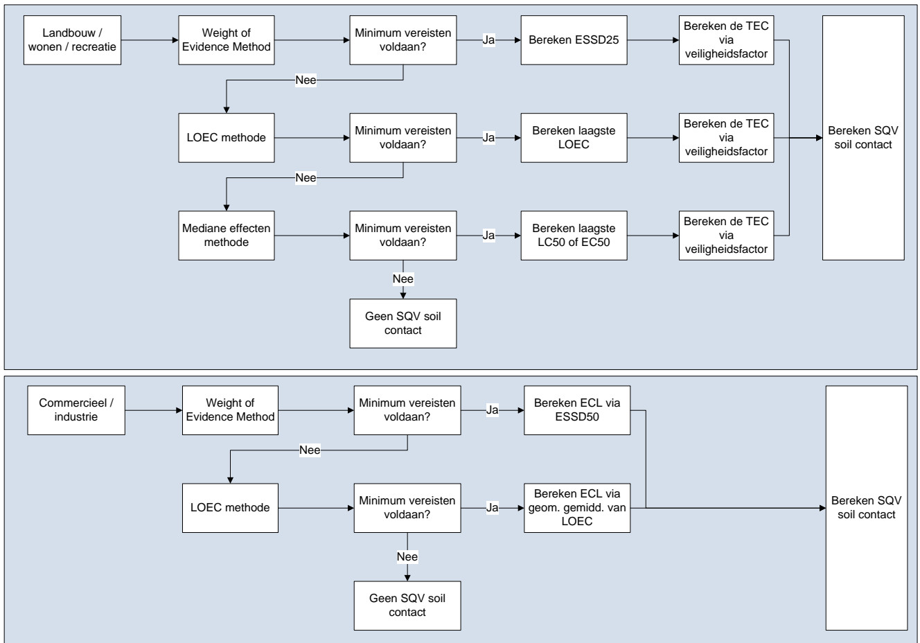
Figuur 3: Schematische voorstelling van de berekening van ecotoxicologische toetsingswaarden voor bodemcontact (SQVsoil contact), zijnde de ecotoxicologische bodemsaneringsnormen; ESSDs: Estimated Species Sensitivity Distribution – xth percentile; TEC: Threshold Effect Concentration; LOEC: Lowest Observed Concentration; LC50: median effective concentration; ECL: Effects Concentration Low
