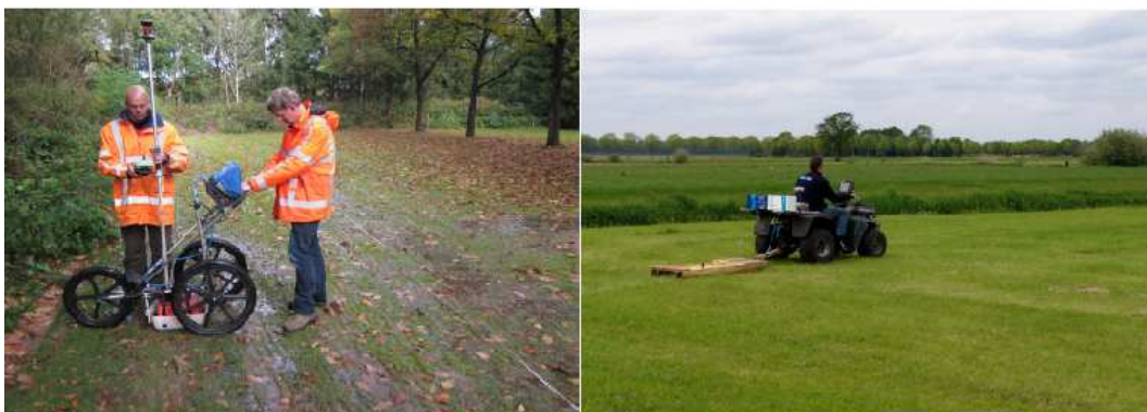
Figuur 34: Voorbeeld van een lopende meting met een GPR en een meting waarbij de GPR (houten omhulsel) achter een quad wordt gesleept. Bron: Medusa
