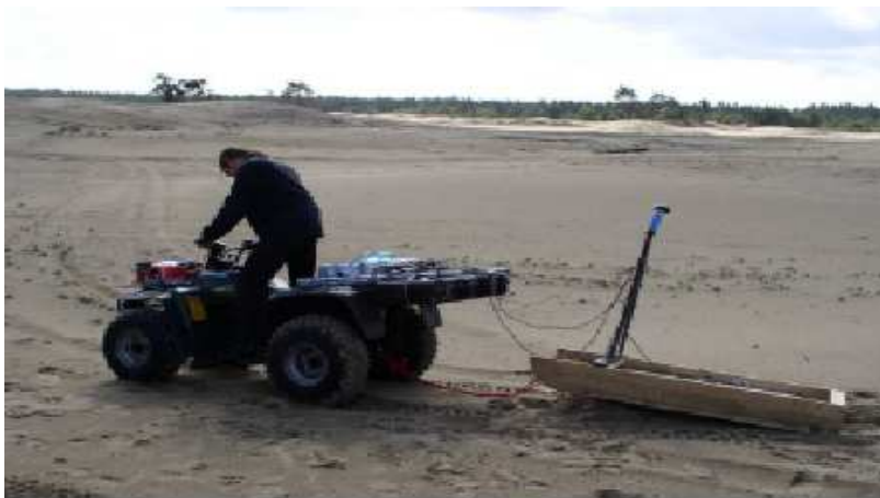
Figuur 40: Met de Medusa sensor wordt de gammastraling uit de grond gemeten. Zinkas zendt meer straling uit dan 'schone bodem'. Bron: Medusa
