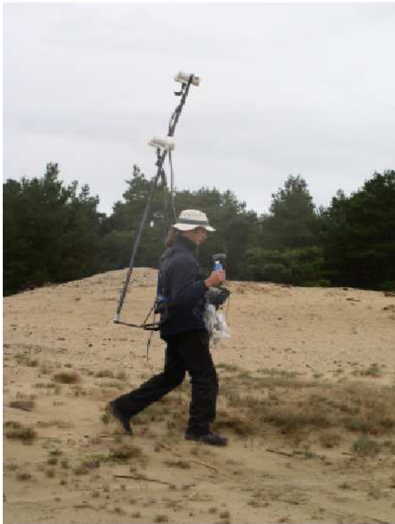
Figuur 35: Voorbeeld van een gradiometer magnetometer in de praktijk. Bron: Medusa
