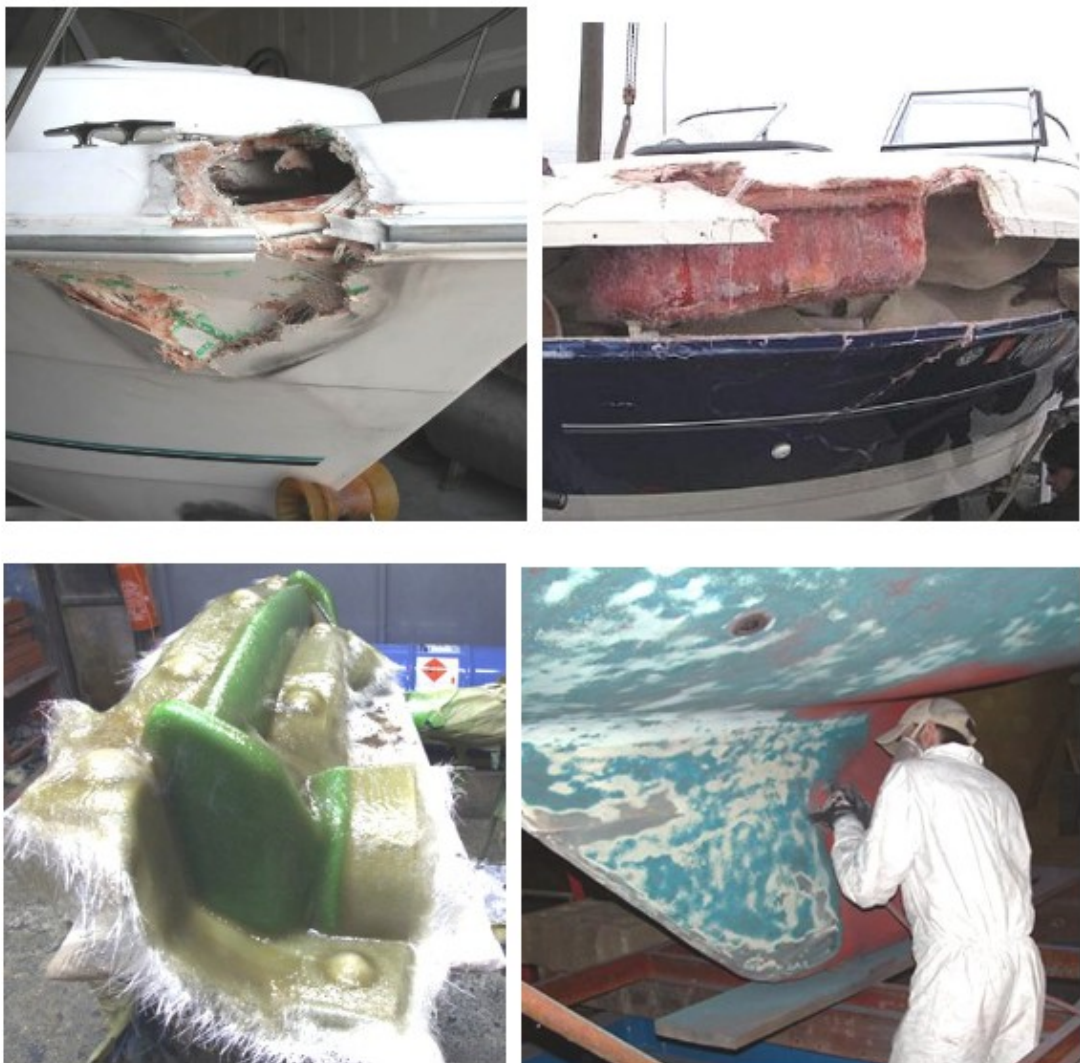
Figuur 55: Reparatie van boten ( http://www.bluebird-electric.net/boat_repairs_mobile_grp_laminating_service.htm )
