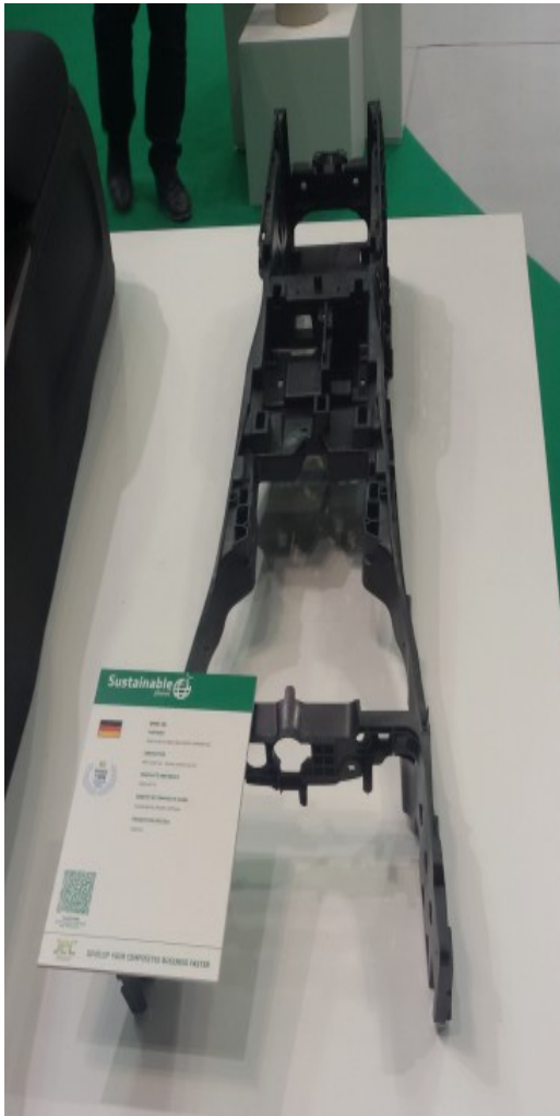
Figuur 47: Midden console van een Mini Clubman, een spuitgietonderdeel gebaseerd op secundaire carbonvezel en PA66 (BMW)
