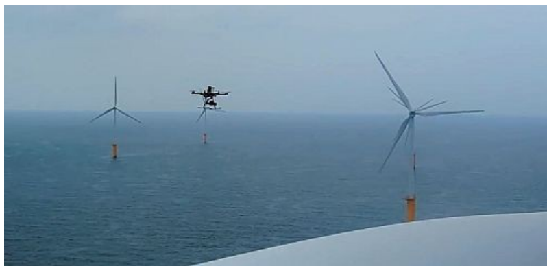
Figuur 62: Inzet van drones voor inspectie van windmolens ( http://www.offshorewind.biz/2015/10/07/drones-becoming-very-important-in-wind-turbine-inspections/ )
