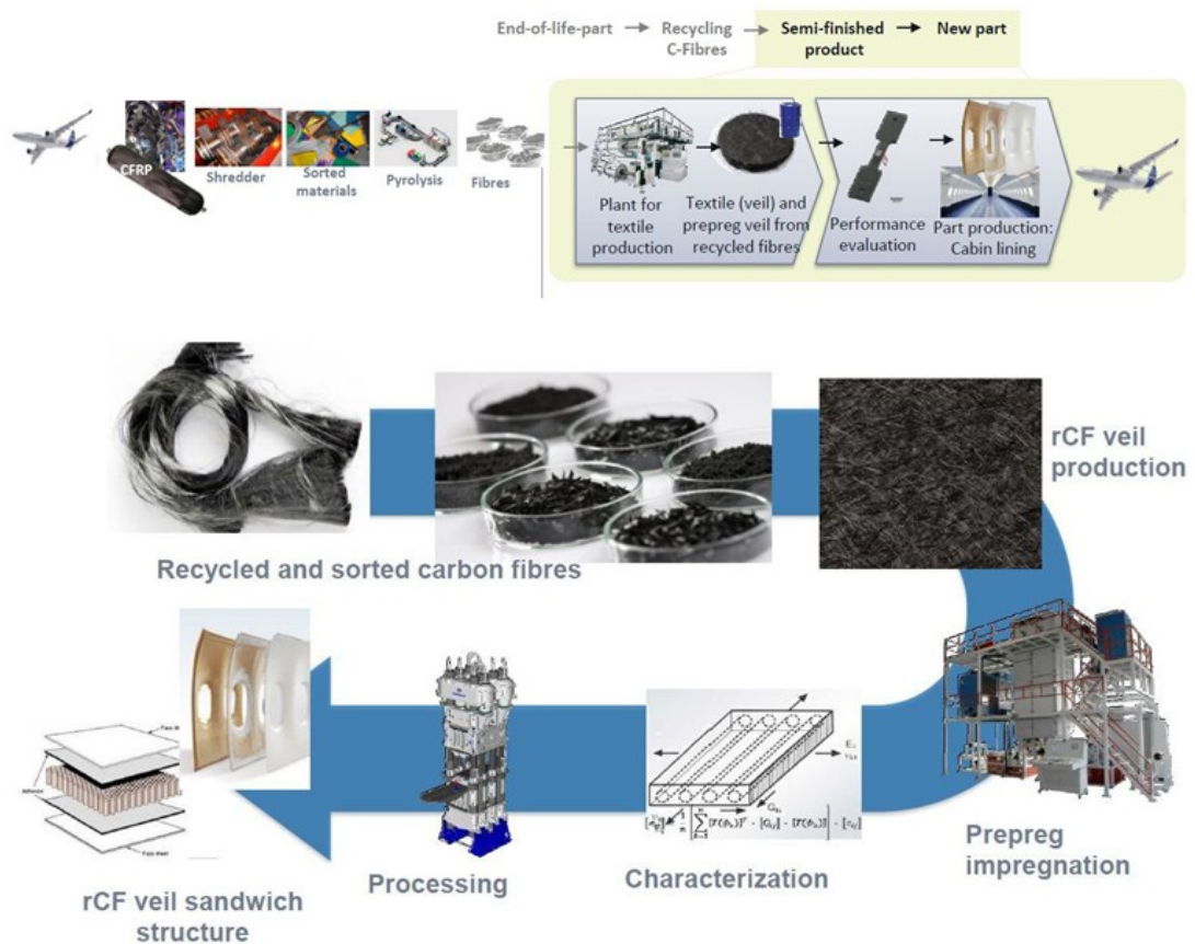
Figuur 38: Recyclage van koolstof vezels volgens volgende stappen: shreddering, sortering, pyrolyse om de vezels te isoleren, productie vezelmat uit gerecycleerde vezels, performantie-testen, product vervaardiging ( http://www.compositesworld.com/blog/post/recycling-carbon-fiber-for-structural-applications )
