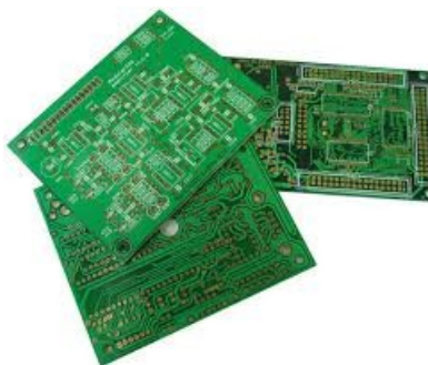
Figuur 15: Toepassing van glasvezelversterkte composieten als dragermateriaal in elektronische printplaten
