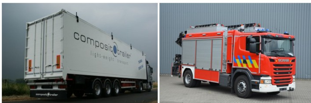
Figuur 14: Toepassing van glasvezelversterkte panelen in vrachtwagens en brandweerwagens
