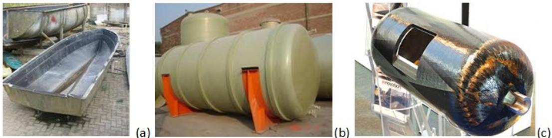
Figuur 8: Toepassingen van composietmaterialen in industriële producten: (a) scheepsrompen (hand lay-up matten), (b) opslagtanks (wikkeltechniek-matten), (c) opslagtanks (wikkeltechniek)
