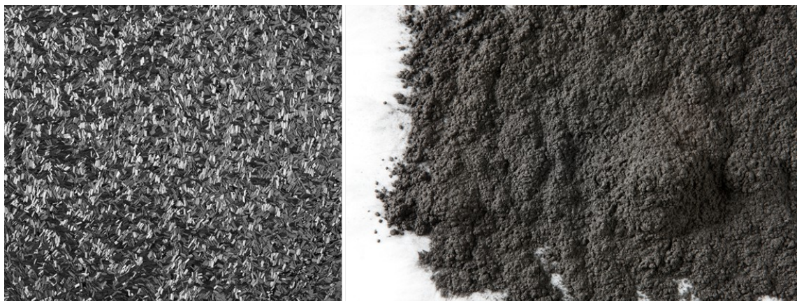
Figuur 42: Recyclage van koolstofvezels (Procotex-BE)
