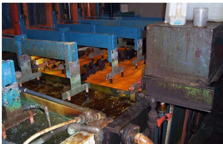
Figuur 12: Verchromingsbad (met oranje schuim) met spoelbaden (EPA, 2009)
