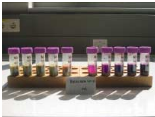
Figuur 36. Eindresultaat permanganaat chemische oxidatietest op materiaal 'Berchem 4,5-5,0 m-mv'.
