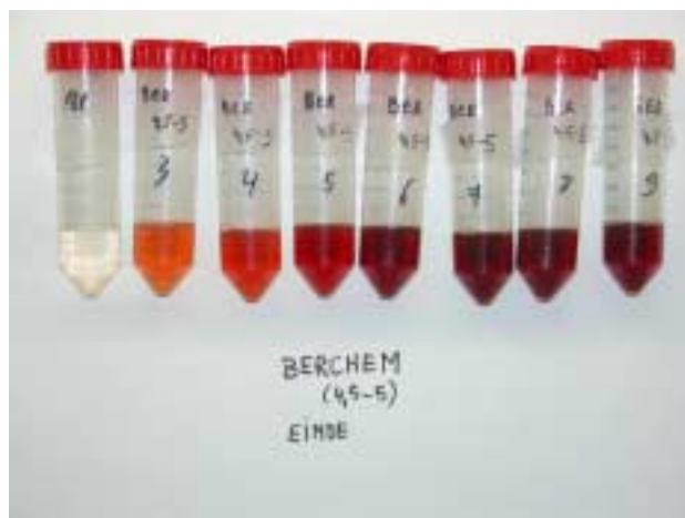
Figuur 40. Oxidatiereeks met persulfaat op 'Berchem 4,5-5 m-mv.'
