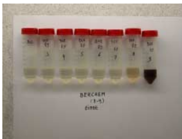
Figuur 41. Oxidatiereeks met persulfaat op 'Berchem 5,3-6 m-mv.'
