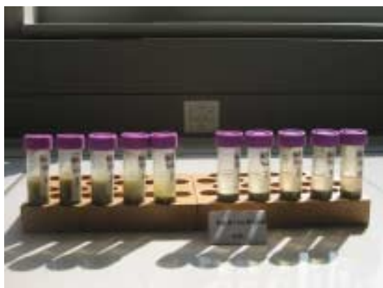
Figuur 37. Eindresultaat permanganaat chemische oxidatietest op materiaal 'Berchem 5,0-6,0 m-mv.'
