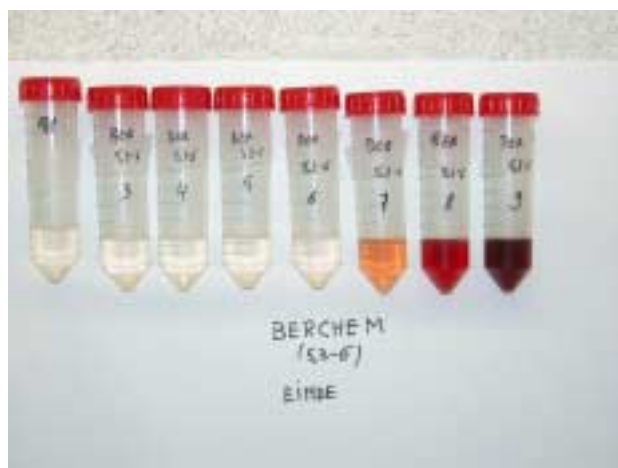
Figuur 40. Oxidatiereeks met persulfaat op 'Berchem 4,5-5 m-mv.'
