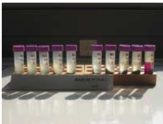
Figuur 38. Eindresultaat permanganaat chemische oxidatietest op materiaal 'Berchem 9,0-10,0 m-mv.'
