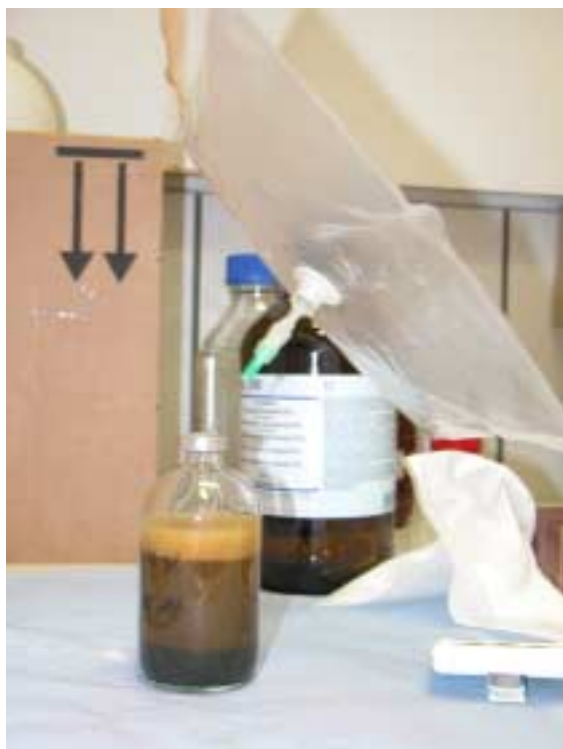
Figuur 43. Proefopstelling met gaszak voor opvang van vrijkomende gassen voor het testen van de efficiëntie van Fenton's reagens voor destructie van VOC's.
