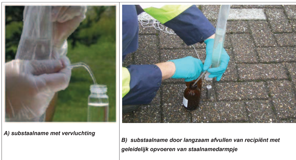
Figuur 17: HydraSleeve™, substaalname voor analyse
