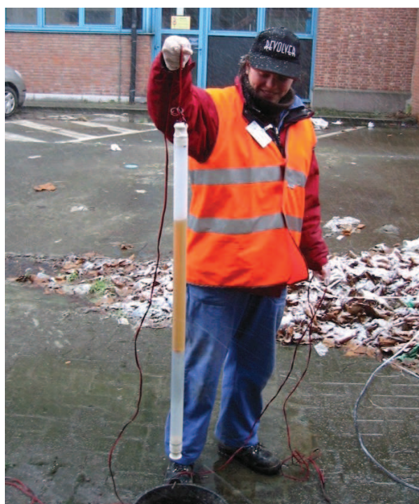
Figuur 20 Staalname LNAPL met behulp van een bailer
