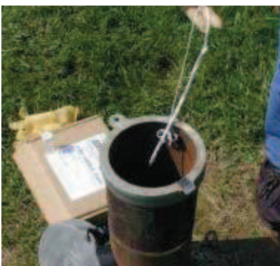
Figuur 30: Gore module; Schematisch overzicht (A) – Plaatsing in een peilbuis (B)
