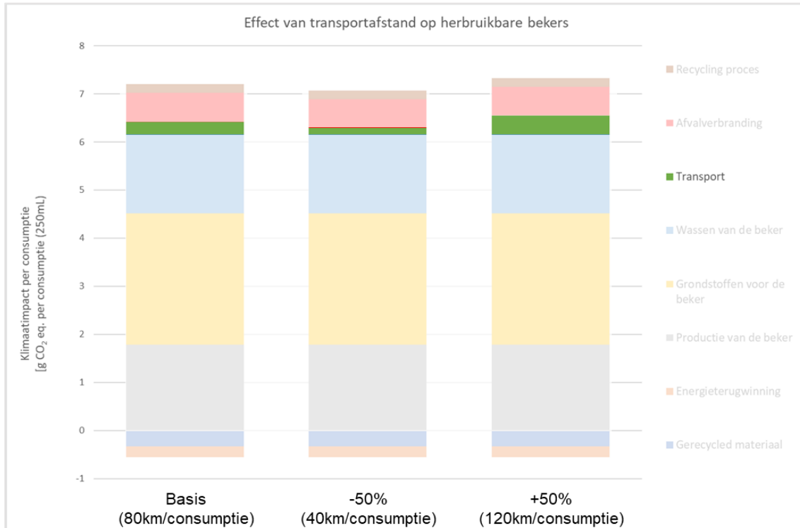
Figuur 6: Effect van transport op herbruikbare beker (PP: 29 gram), 20 consumpties per beker en gerecycled na levensduur
