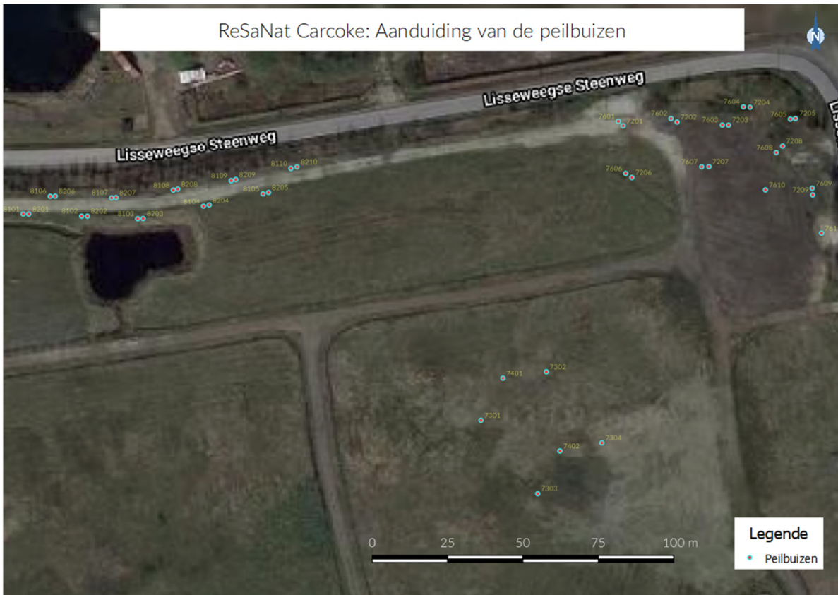
Figuur 2: Boorplan met aanduiding van de peilbuizen ter hoogte van de 3 zones
