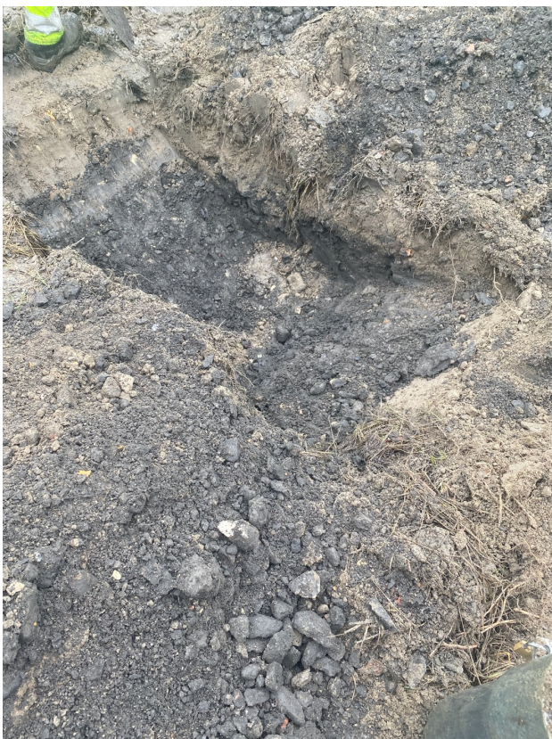
Figuur 2: dikke puinlaag bij uitgraving
