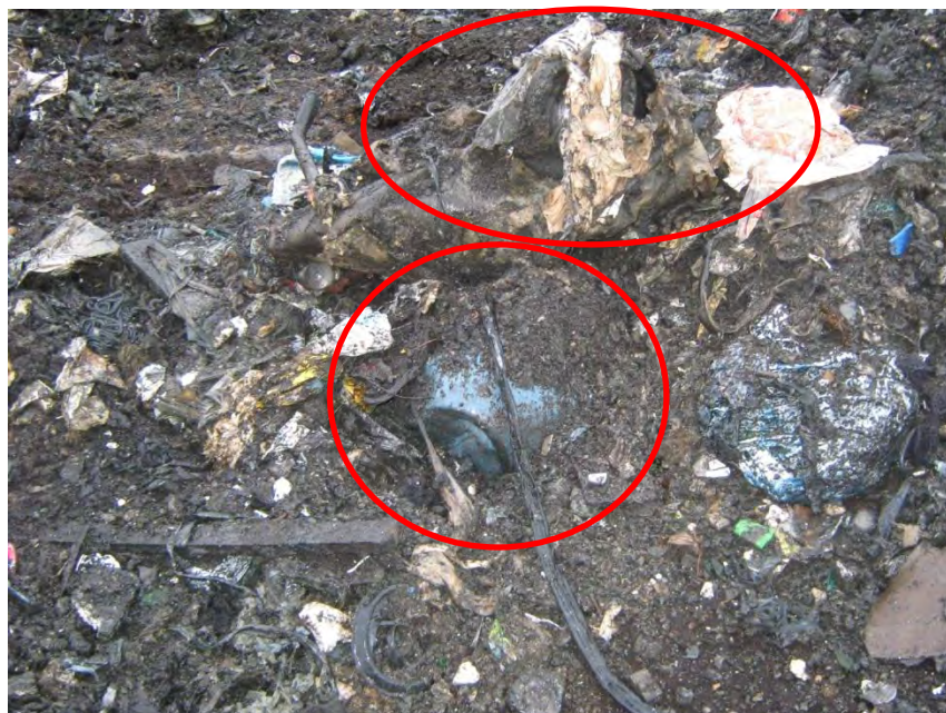
Foto 7 : Vaststelling aanwezigheid niet geïdentificeerde bidon en isolatiemateriaal
