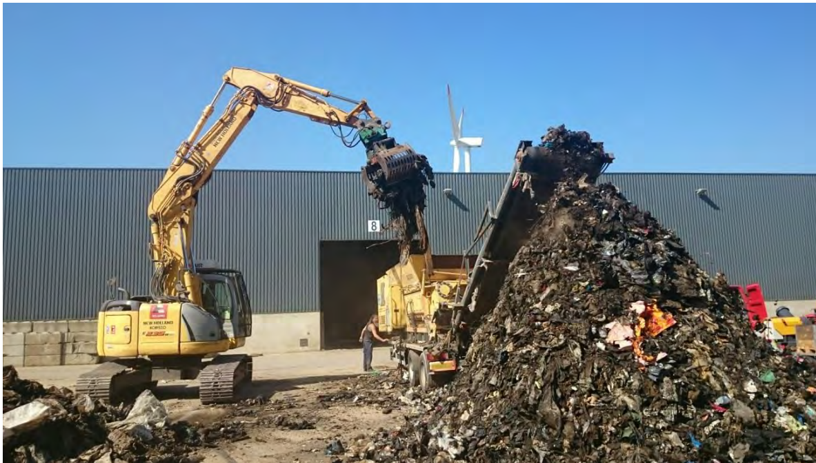
Foto 20 : Tweede scheiding: Stap 1 - shredderen
