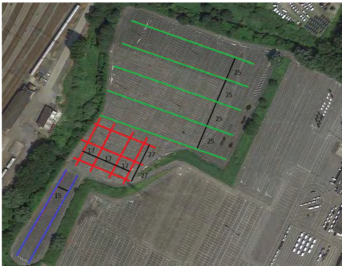
Figuur 2: Lay out van het meetraster op het terrein
