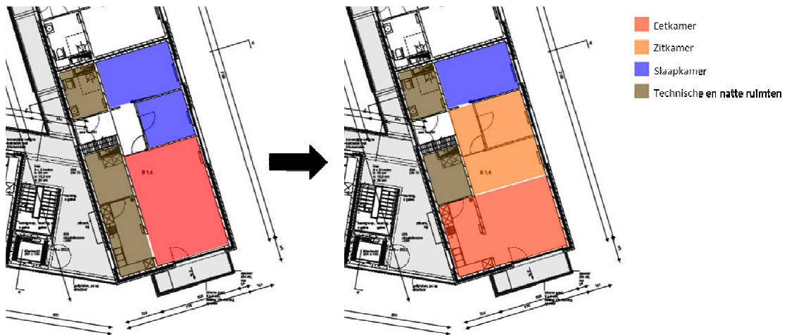
Figuur 77: Verbouwingsingrepen in scenario 2 (Typewoning gebouw B - Perceel 1 - Gandhiwijk)
