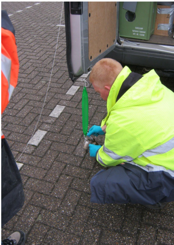
Afbeelding 2: Uitvoeren PDB bemonstering, overgieten in recipiënt
