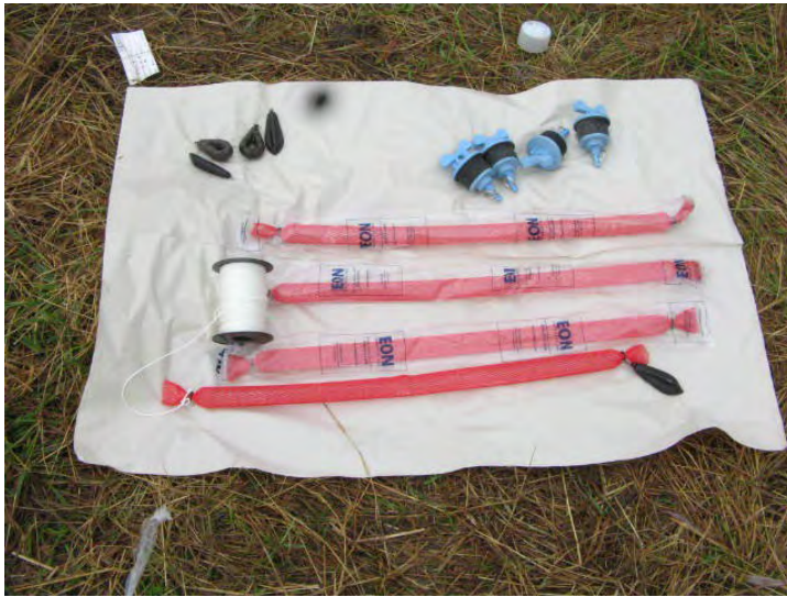
Figuur 3: Materiaal vereist voor PDB grondwaterstaalname
