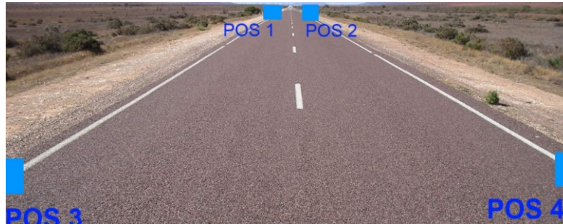
Figuur 27: Mono-fotogrammetrische rectificatie
