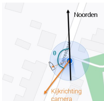
Figuur 37: Rotatiehoek voor oriëntatie camera
