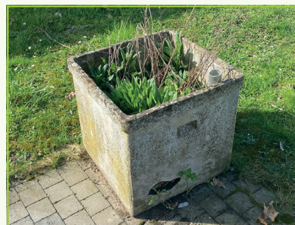
Lege asbestcementen bloembakken
