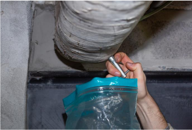
Figuur 63: Voorbeeld van een zorgvuldige monsterneming van thermische leidingisolatie in gips met kurkboor
