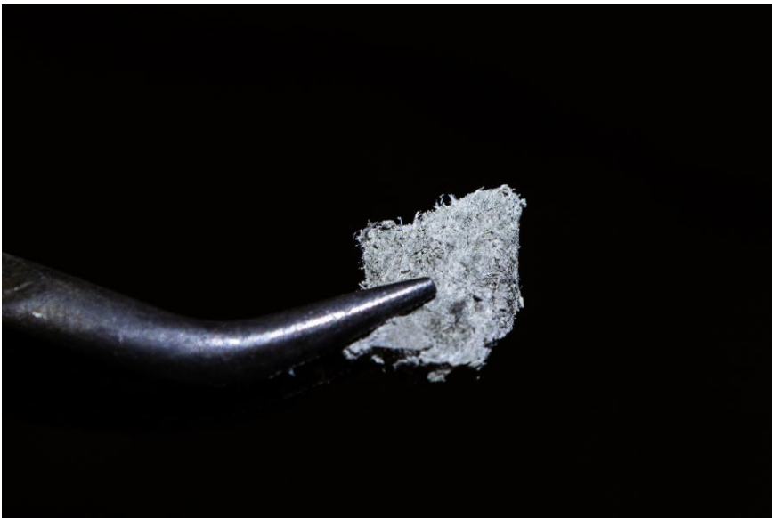
Figuur 70: Voorbeeld van monstername van vezelcement met bektang, monster is ca. 1 cm 2
