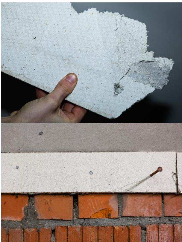
Figuur 54: Platen type "Pical" (boven) en type "Promatect" (onder) vertonen sterke gelijkenissen en zijn allebei te beschouwen als asbestverdacht indien geproduceerd vóór 2001
