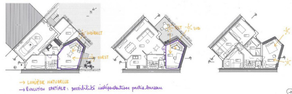
Door bij een uitbreiding van de woning 'Dupontgaarde' een aparte toegang en interne circulatie te voorzien kan het later ook los van de woning gebruikt worden, bijvoorbeeld voor een vrij beroep, een studentenkot of als kangerewoning. ©VLA-Architecture
