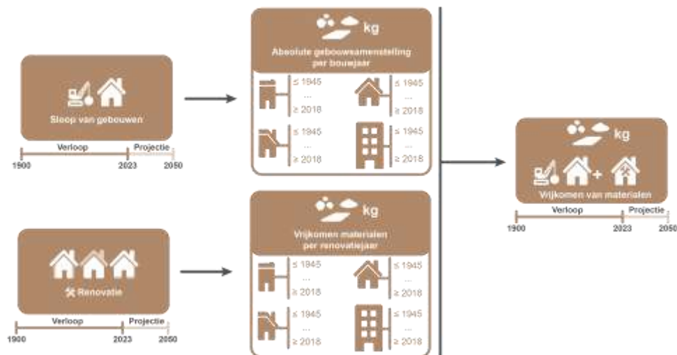
Figuur 16: Schematische weergave van de koppeling met materialen aan de sloop in het Vlaamse residentiële gebouwenpark.
