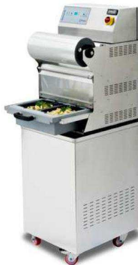
Afbeelding 23: Half-automatische MAP verpakkingsmachine (foto: DECATECHNIC, Herentals)
