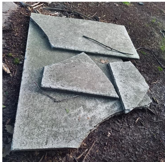
Figuur 2418: Voorbeeld van een niet-constructie: stukken van platen in vezelcement (afval)
