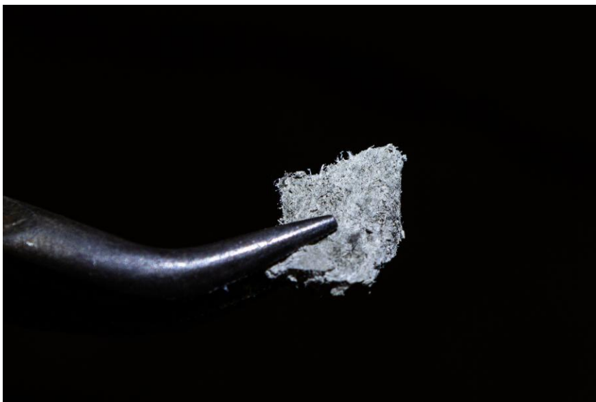
Figuur 2932: Voorbeeld van monstername van vezelcement met bektang, monster is ca. 1 cm 2
