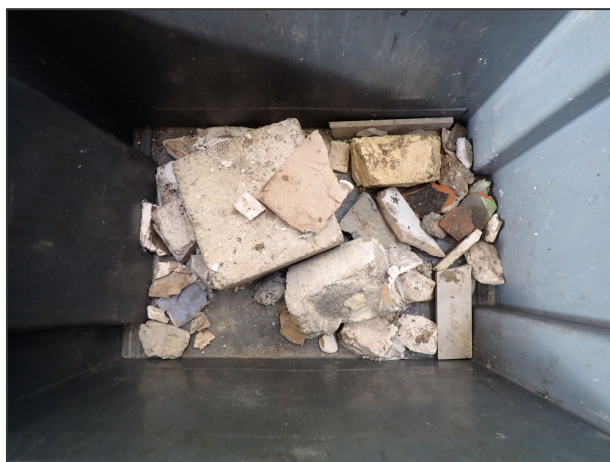
Foto 46. Bouw- & sloopafval – puin
