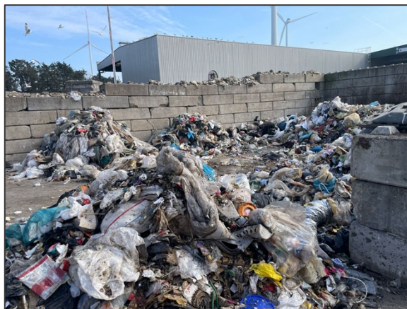
Foto 1. Voorbeeld van de methode 'menging, kwartering en reducering' tijdens de sorteeranalyse
