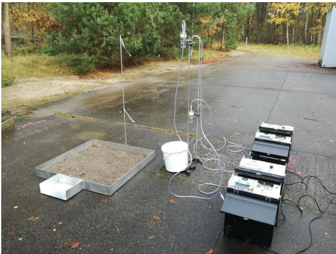
Figuur 12 Opstelling buiten simulatie met bak grond van 1 x 1 meter met windvanen en windafwaartse bemonstering van luchtstalen voor SEM en TEM op 1,5 en 0,6 m+mv
