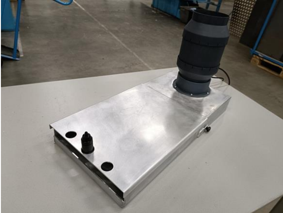
Figuur 10 Simulatie toestel met ventilator, bak voor grond en openingen voor filtercassettes.
