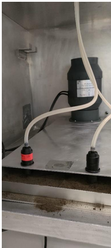
Figuur 11 Simulatie toestel met bak (0,3 x 0,4 m) gevuld met grond (0,03 m) in handschoenkast, links: open bak, rechts: gesloten bak met 2 filtercassettes. De onderzijde van de cassettes bevinden zich circa 2,5 cm boven het grondoppervlak (Figuur 11).
