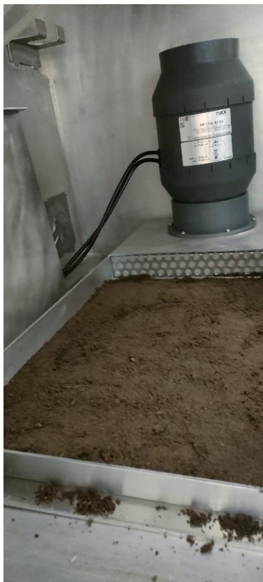
Figuur 11 Simulatie toestel met bak (0,3 x 0,4 m) gevuld met grond (0,03 m) in handschoenkast, links: open bak, rechts: gesloten bak met 2 filtercassettes. De onderzijde van de cassettes bevinden zich circa 2,5 cm boven het grondoppervlak (Figuur 11).
