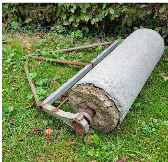
Figuur 22: Voorbeeld van een niet-constructie: asbestcementen tuinwals in gebruik (roerend goed)
