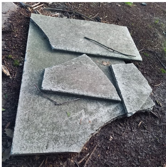
Figuur 23: Voorbeeld van een niet-constructie: stukken van platen in vezelcement (afval)
