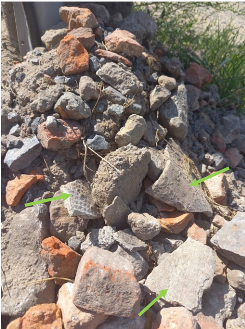
Figuur 51: Voorbeeld van opliggende resten in vezelcement op steenpuinlaag
